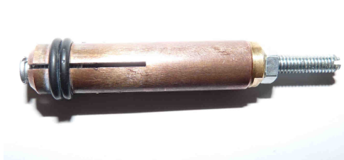
Embout en cuivre à 4 fentes pour souder les goujons M4 (diamètre Ø 4 mm)
